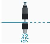
Sistema di aspirazione collegato alla parte inferiore dei perforatori
